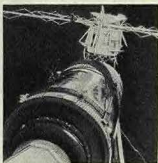
Станция «Скайлэб» на орбите (стрелкой показаны обрывки проводов в месте отрыва панели № 2). Снимок сделан из ТК после сближения со станцией.
