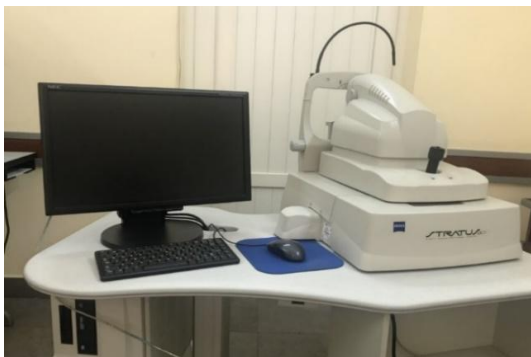
Рис. 1. Оптический когерентный томограф «Stratus OCT-3» (производство «Carl-Zeiss Meditec», США): модель 3000 (Instrument and Stratus Review Software Version 6.0)
