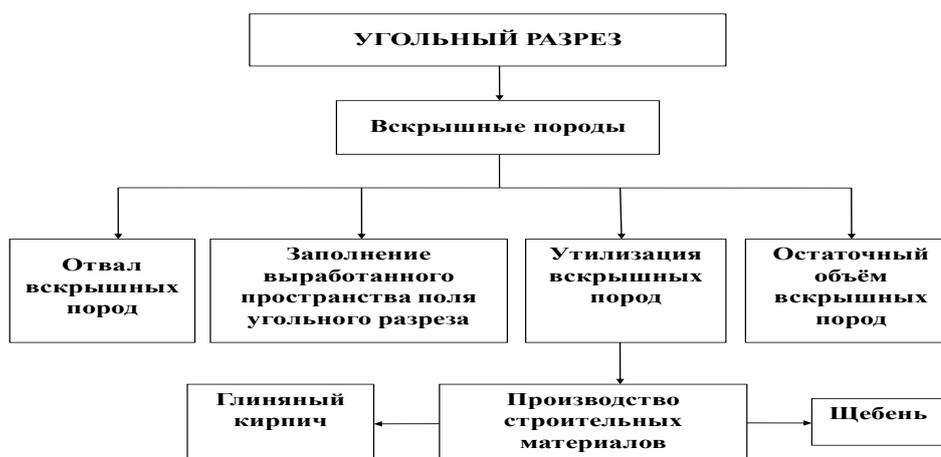
Рис. 7.1. Возможные направления распределения и утилизации вскрышных пород угольного разреза
