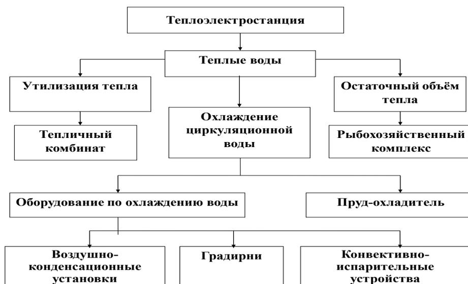
Рис. 7.3. Направления распределения и утилизации теплых вод ТЭС
