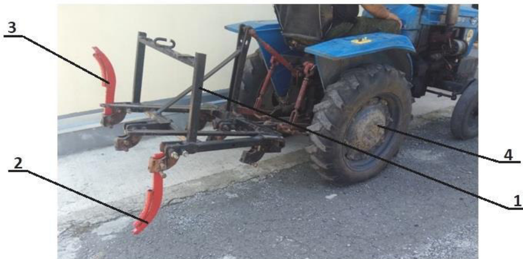
Рис.3. Лабораторный образец агрегата для щелевания деградированных горных лугов и пастбищ на базе минитрактора «Феншоу-180»: 1 – рама агрегата; 2- рабочий орган щелереза в рабочем состоянии; 3 - рабочий орган щелереза в транспортном состоянии; 4 – минитрактор «Феншоу -180».
