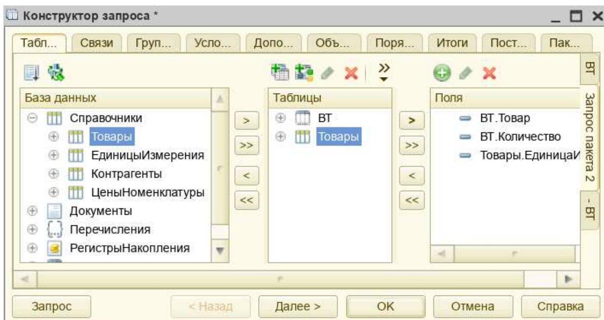
Рис. 8.9. Вкладка «Таблицы и поля» конструктора запроса с несколькими таблицами-источниками
