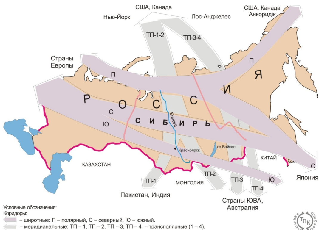
Рис. 10.2. Коридоры межконтинентальных трасс в воздушном пространстве Сибири (рисунок выполнен на основе оригинального варианта, представленного в «Cross-Polar Flight Over the Northern Pole», Krasnoyarsk–Washington, D.C. 1997)
