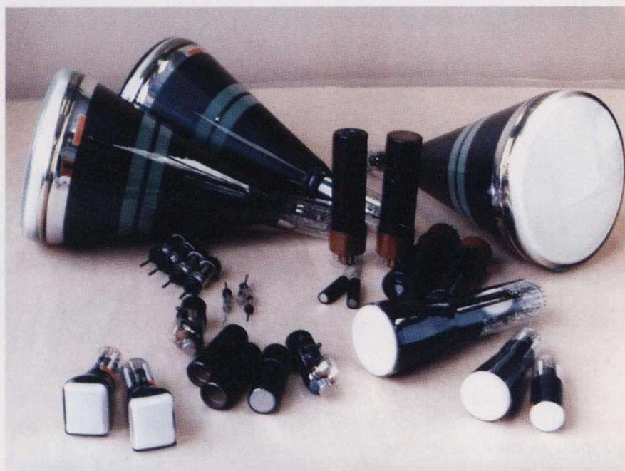
*Многолучевая осциллографическая ЭЛТ 10Л0101М
