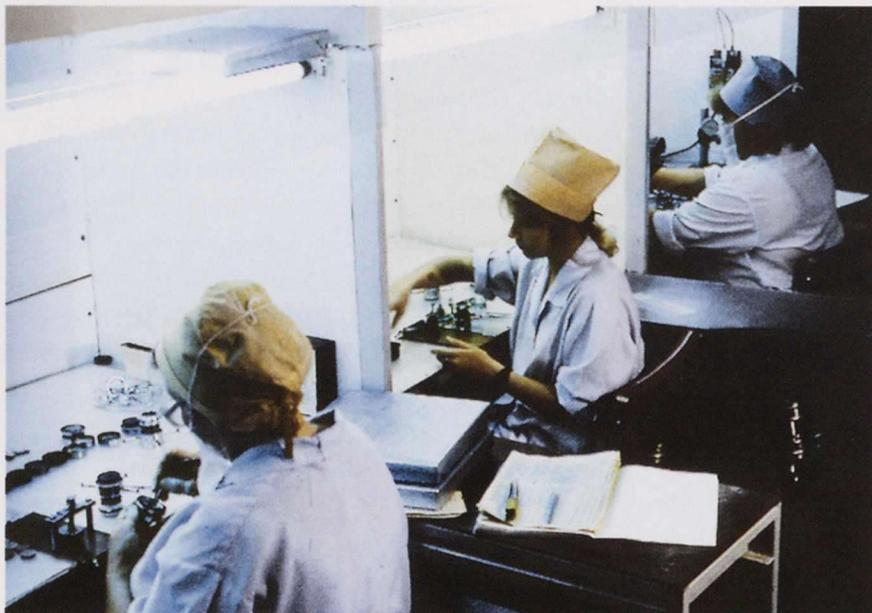
*Участок сборки электроннооптической системы ЭОП*
