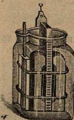
4. Элементы Лек анше съ 2 агломератами, у средняго угла мѣднѣй клеммъ для проводника съ цинкомъ, съ изолятор. между агломератомъ и цинк., въ четырехугольной банкѣ. Тоже французск. 1.60
